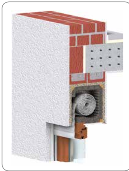
Pyramidenförmiges, selbstklebendes, flexibles Grupor® Rollladenkasten-Sanierungssystem S
